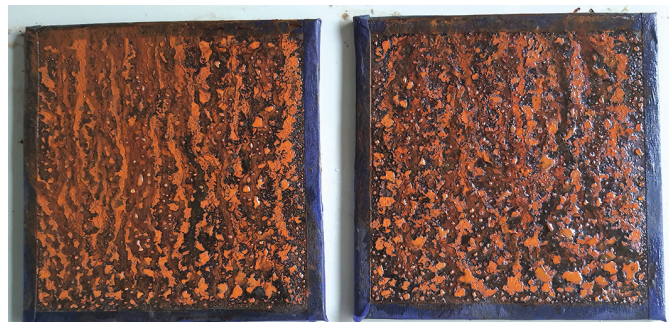
Fot..2. Badania korozyjne stali czarnej
